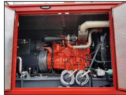
Scania Industriemotor 12700cm 3 /495PS Einbaugenerator 230/400V Mecc Alte
