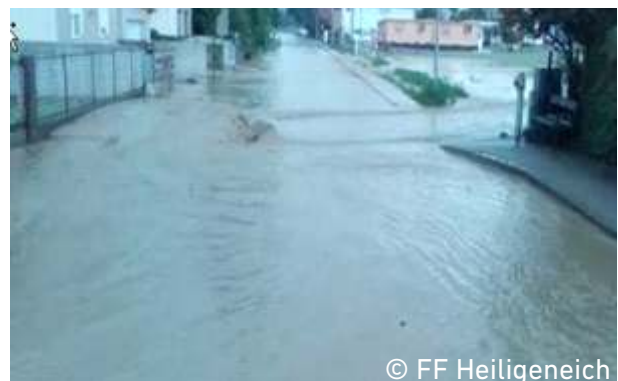
Abb. 3: Fließweg quert Aufschließungszone und quert Straße am Tiefpunkt
