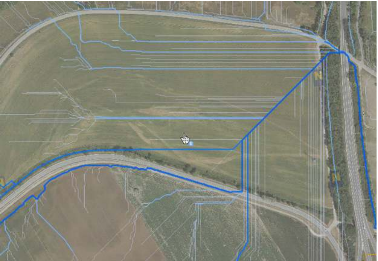
Abb. 9: Vom Modell identifizierter Rückstaubereich, erkennbar durch die 45°-Winkel zwischen den Fließwegen. Vom tiefsten Punkt aus (Autobahn) wird vom Modell eine Senke errechnet, die Straße unterhalb der Autobahn wird nicht als Tiefpunkt erkannt.
