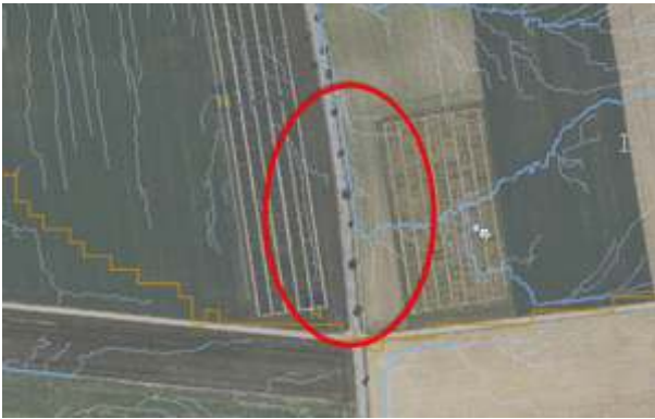
Abb. 4: Fließweg quert Bundesstraße, die Überströmungsstelle ist auf der Fließwegekarte nicht ersichtlich
