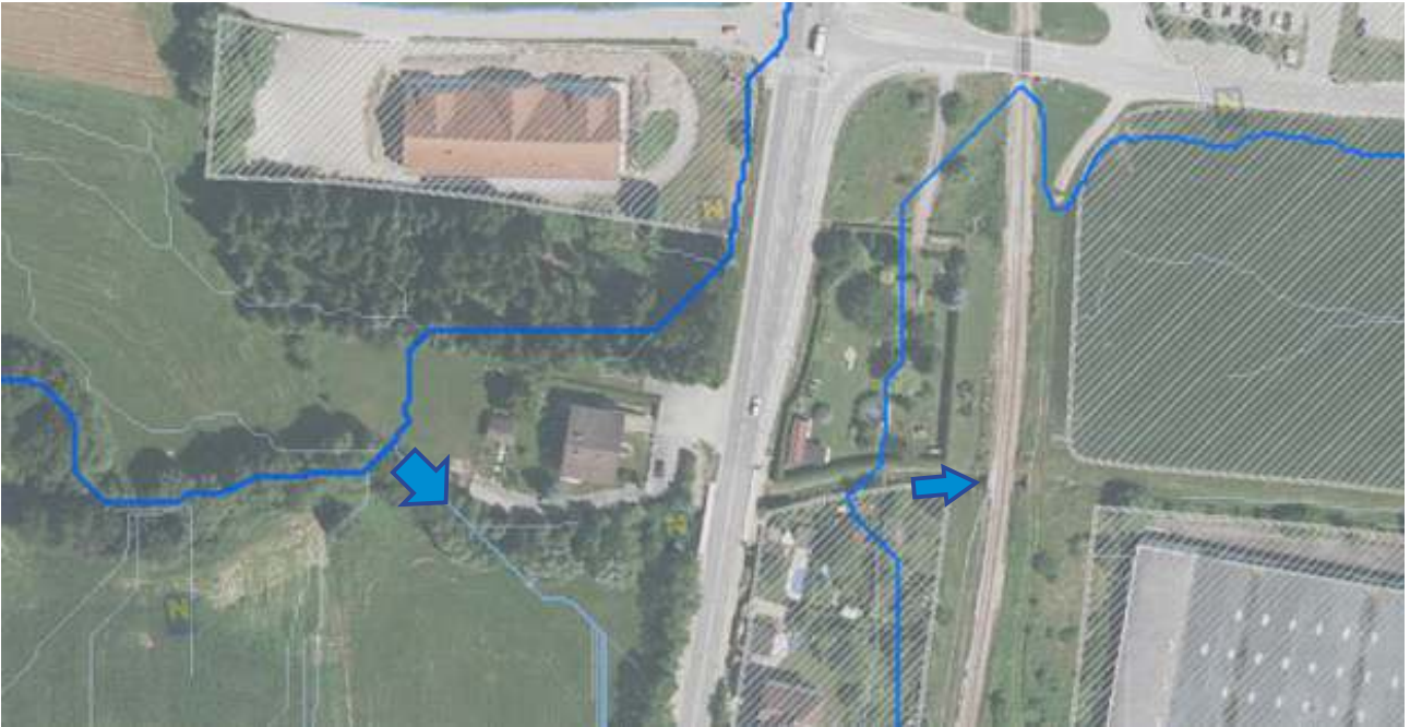
Abb. 7: Falscher Fließweg wegen nicht Erkennen von Brücken und Durchlässen
