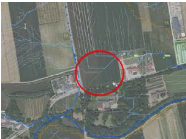
Abb. 5: Fließwege zeigen Rückstau (45° Abflussrichtung) an, die Geländemulde hat sich mit Wasser angefüllt
