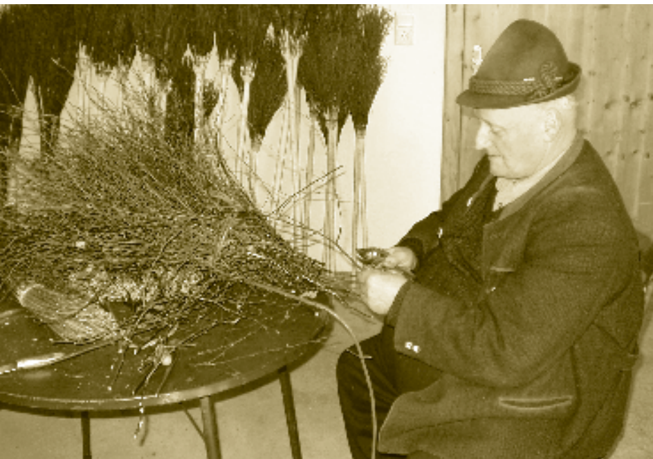
Vor dem Besenbinden muss das Reisig geputzt werden. Dabei werden alle überzähligen Verzweigungen abgeschnitten und die Zweige auf gleiche Länge gebracht.
