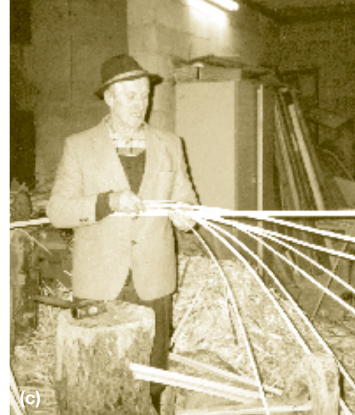
Durch das Abklopfen spaltet sich das Eschenholz entlang der Jahresringe in lange Schienen.
