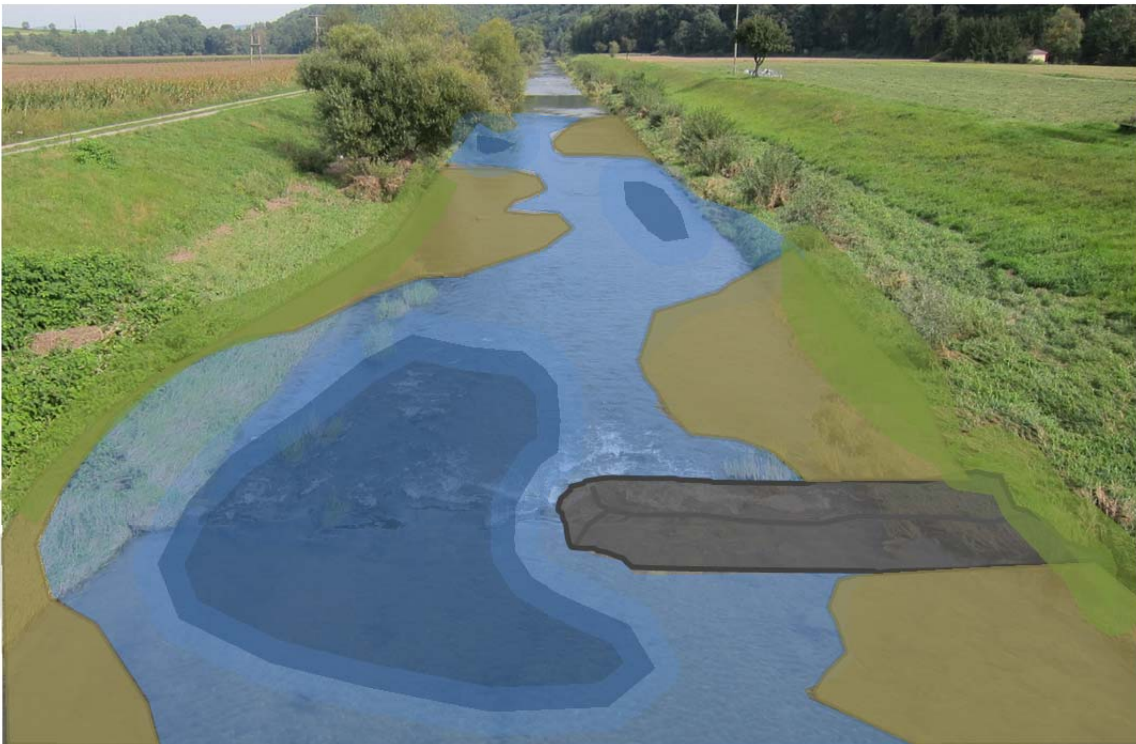
Abbildung 63: Melk flussab von Zelking; oben Bestand, unten: mögliche Strukturierung durch Buhnen und abschnittsweise Rückverlegung des Uferdeckwerks; Entwicklung von Kolken, Rinner, Kiesfurten, Flachufer, tiefen und seichten Buchten, Kiesbänken und lückigen Blockwurfuferrn
