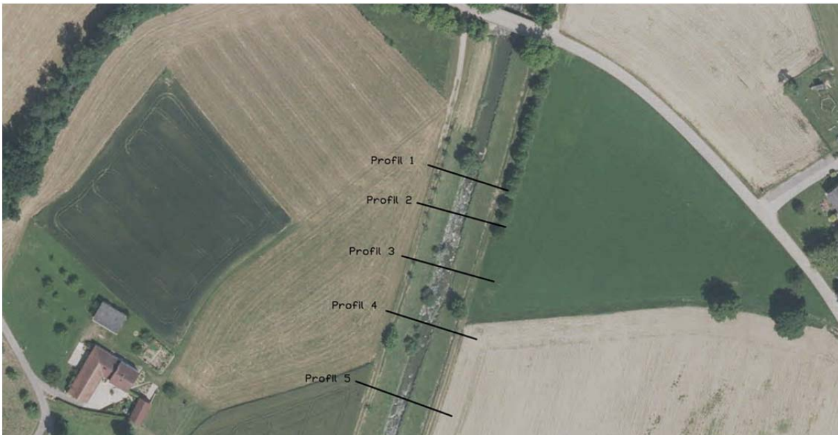
Abbildung 51: Lage der Vermessungsprofile im Bereich der Regulierungsstrecke Kerndl (ca. 1,7 km flussab der Bühnenstrecke Hofstetten)
