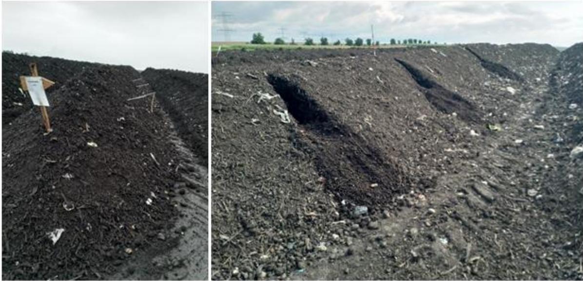
Abbildung 3: Vor der Probennahme wurde die Rottetemperatur und Porenluftzusammensetzung mit Hilfe von Messlanzen analysiert (links). Erst danach wurde die Miete geöffnet und Proben entnommen
