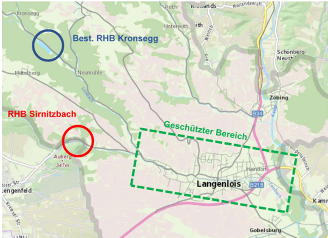
Abbildung 1 Konzept, Hochwasserschutz Langenlois / Loisach (RHB-System)
