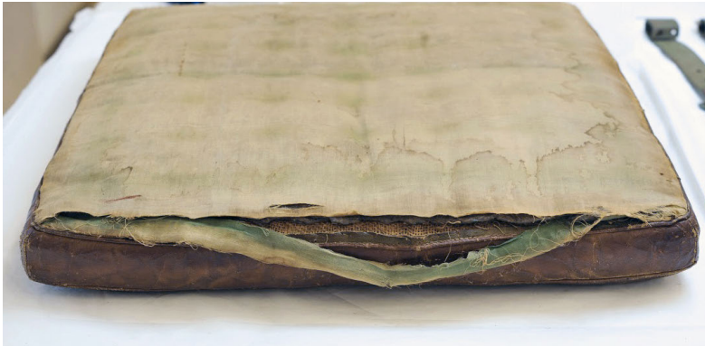
Originaler Barcelona-Hocker aus dem Haus Tugendhat aus dem Jahr 1930, Rückseite des lichtgeschädigten Sitzpolsters vor der Restaurierung, in den Nahtzugaben ist noch der ursprüngliche Farbton zu erkennen, 2014
