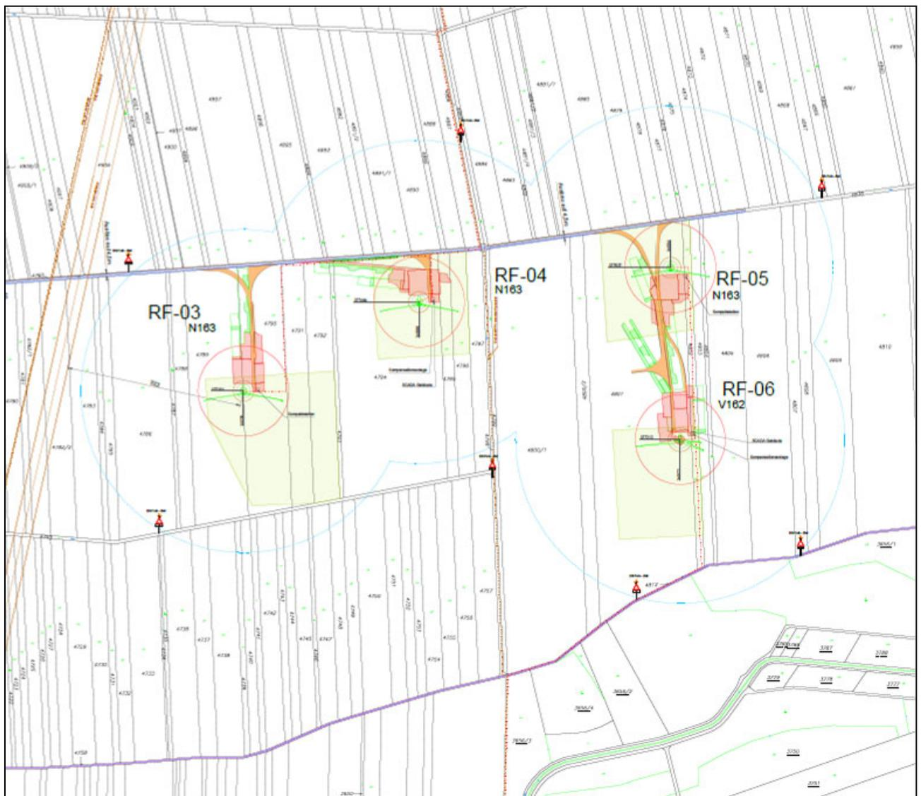
Abbildung: Übersichtsplan Eiswarnleuchten (Quelle: Einreichunterlagen, Einlage B.02.02.00-00)
