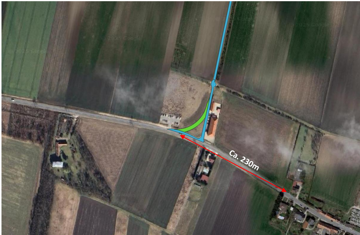
Abbildung 10: Planausschnitt mit (Mindest-)Sichtweiten bei der Windparkeinfahrt (Rot)
