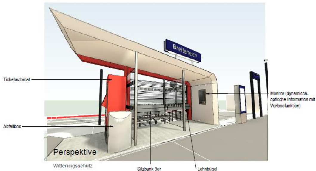
Abbildung 2: Ansicht Aufnahmegebäude Haltestelle Breitenreich (Ausschnitt Einlage 460_03)
