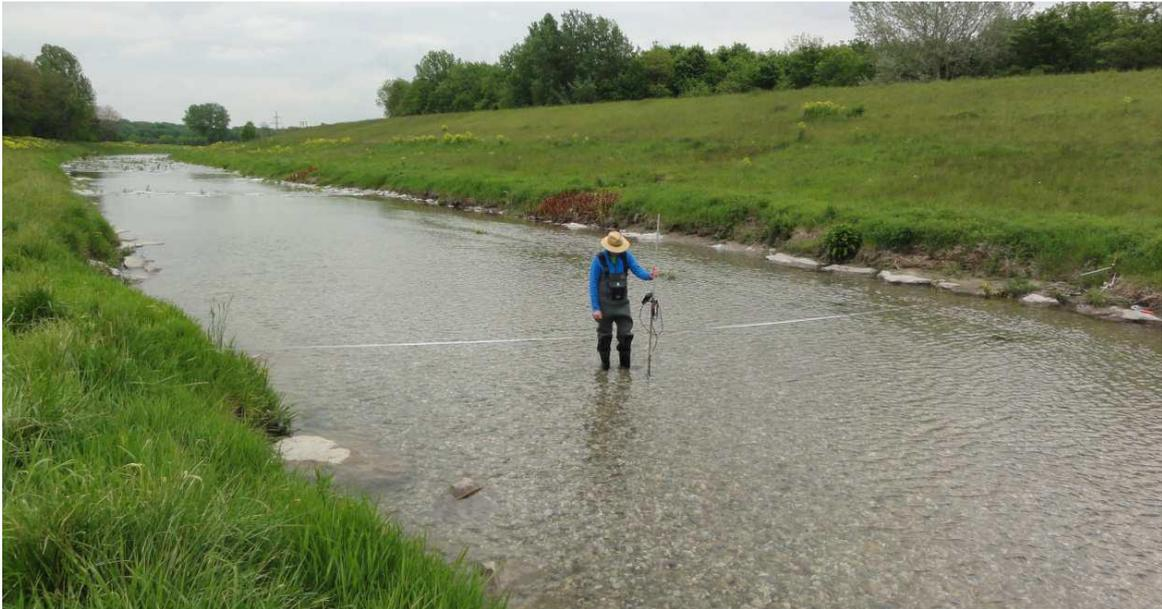
Abbildung 15: Querprofil-Messung Strecke 3 (10.05.2016 - Büro Pieler)
