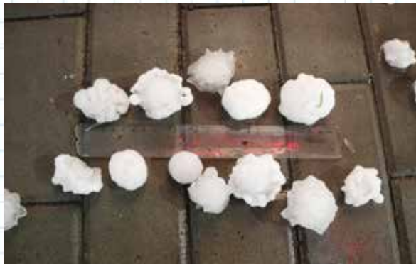
Hagel wird vermessen, um erforschen zu können, ab welchem Durchmesser und Gewicht man mit welchen Schäden rechnen muss
